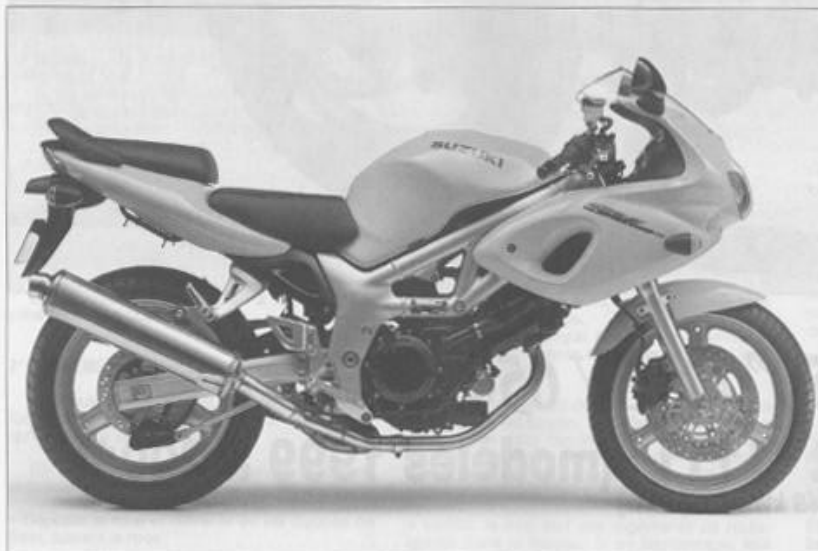
▷ Le modèle sportif, la SV 650 S se différencie par son carénage de tête de fourche mais aussi par le montage de guidons bracelets.
